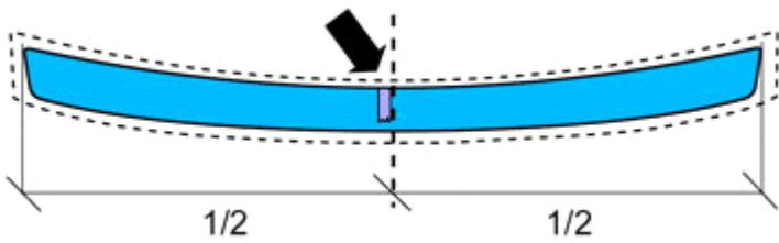
Mit einem geeigneten Klebeband die Mitte kennzeichnen.
