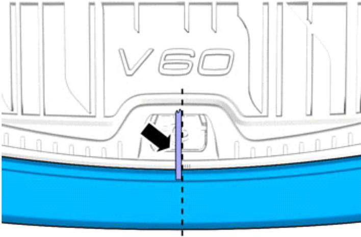
Mit einem geeigneten Klebeband die Mitte kennzeichnen.
